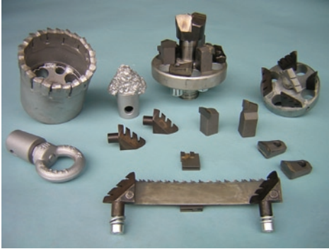
Fotot visar sågblad, hårdmetallskär, dragring och specialsivvel.
